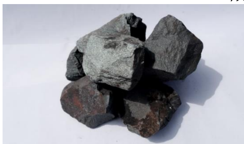
高炉块矿：90%以上产品粒度在 8~40mm
