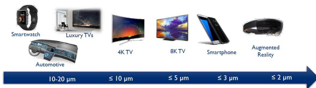
(图：Micro LED 显示应用场景及对应 LED 芯片尺寸 来源：Yole, Micro-LED Display Report 2021)
