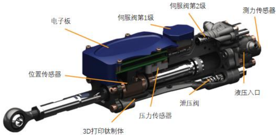
电液驱动关节结构示意图
