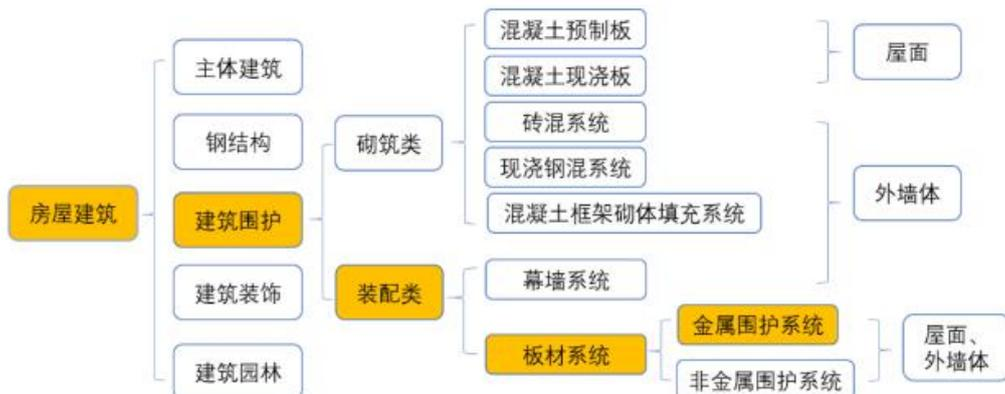
建筑金属围护系统是以金属材料作为围护系统的承重和连接骨架，利用金属板作为围护材料，在钢结构建筑上配合防水、保温、隔热、隔声等材料，完成围护系统的各项功能要求。钢结构建筑是可循环使用的绿色建筑，能促进我国建筑业走向产业化、信息化、智能化，符合我国建筑行业绿色发展和生态文明建设的长远目标。而金属围护系统是钢结构行业中应用领域的细分之一，目前已广泛应用于工业建筑、民航建筑、文化建筑、体育建筑、会展建筑等众多领域建设中。
