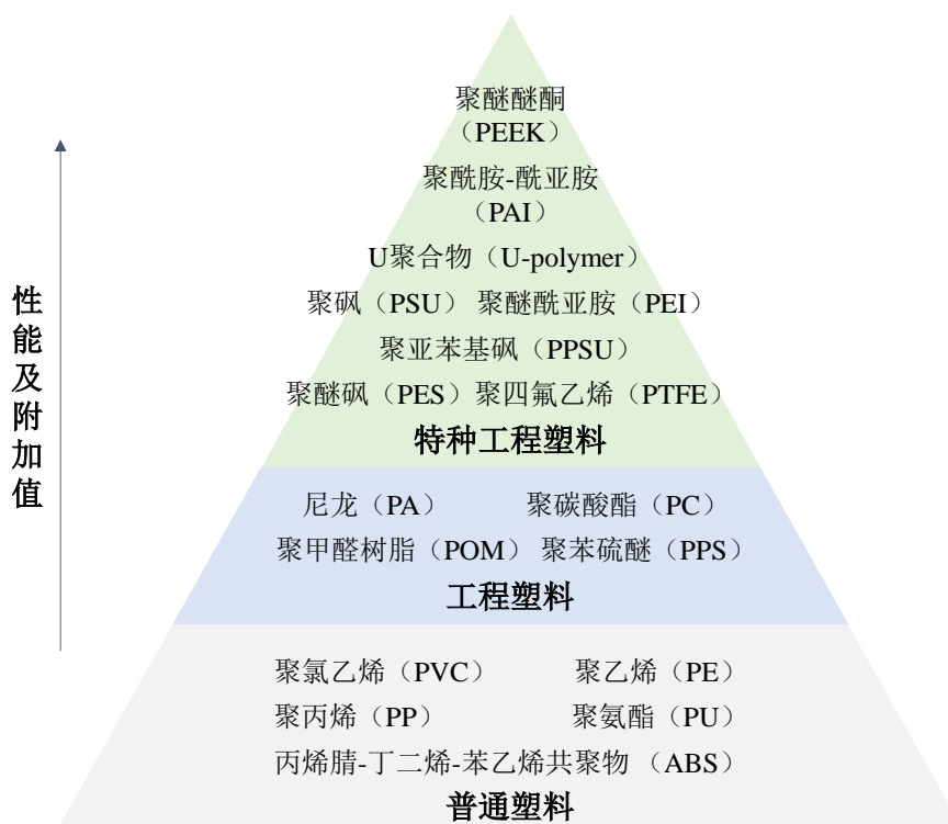
常用普通塑料、工程塑料及特种工程塑料示意图
