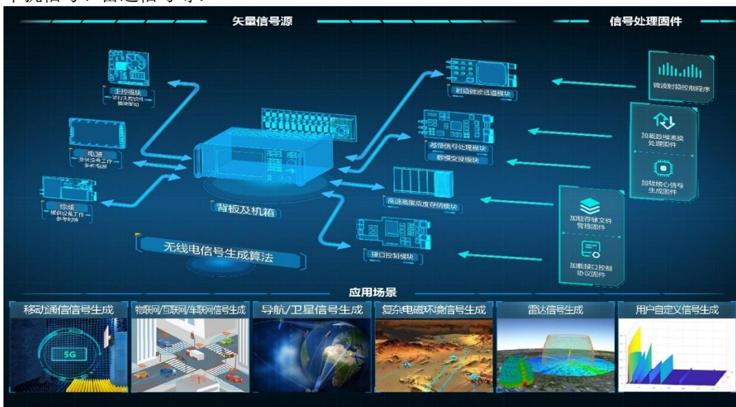
射频微波信号发生器架构及应用示意图
