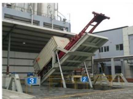
集装箱卸料实景图
