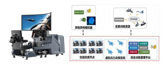
便携式通用数字空战仿真系统具有沉浸式虚拟训练环境、仿真 HOTAS、便携式座椅等设备,能够灵活配置节点数量,可以满足中远距空战、视距内格斗、空面打击、编队飞行、转场演练等仿真训练任务。便携式通用数字空战仿真系统已实现与实装飞机、虚拟兵力的 LVC 互联,并在多个演习任务中发挥重要作用。该产品目前已交航空兵一线部队、试验训练基地、院校等单位,为提升部队战斗力发挥了重要作用。
