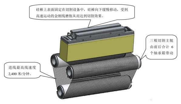
目前应用于切割光伏硅片的金刚线的母线直径在30-34µm之间,母线直径比人体头发丝 (80-90µm) 还要细;硅片半片厚度最薄可至60µm (A4纸的厚度约为104µm);另外,硅片有多个严苛的表面质量指标。
