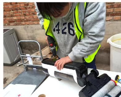
产品拆解—拆卸洗地机电池
