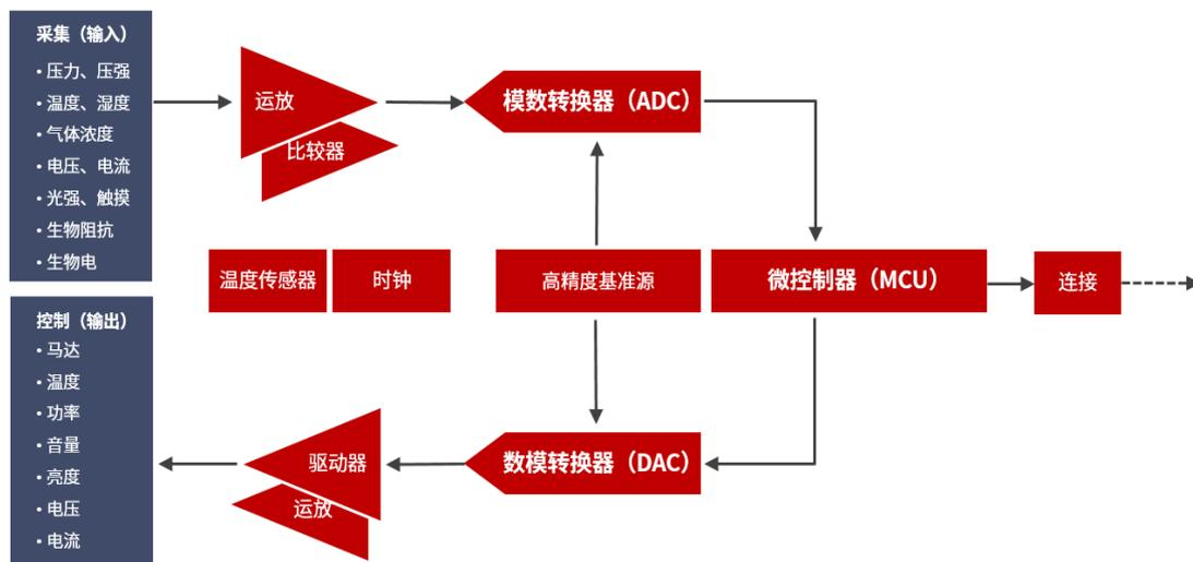
芯海科技拥有完整的信号链芯片设计能力，核心平台技术为高精度 ADC 技术及高可靠性 MCU 技术。
