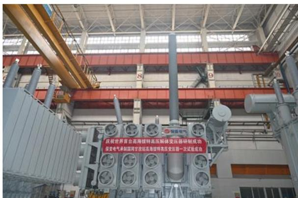
图为：世界首台海拔最高现场组装式特高压 1000 千伏现场组装主变压器试制成功
