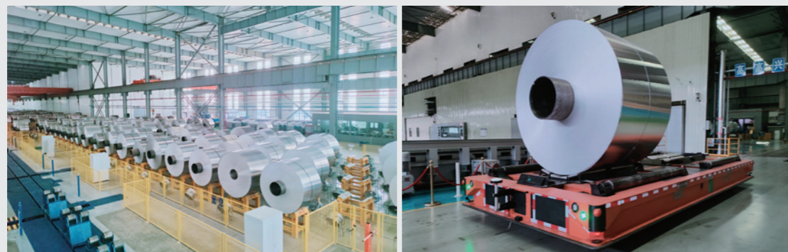
图：智能物流装备代替人工完成易拉罐罐体、罐盖、拉环料及汽车板料等运输
