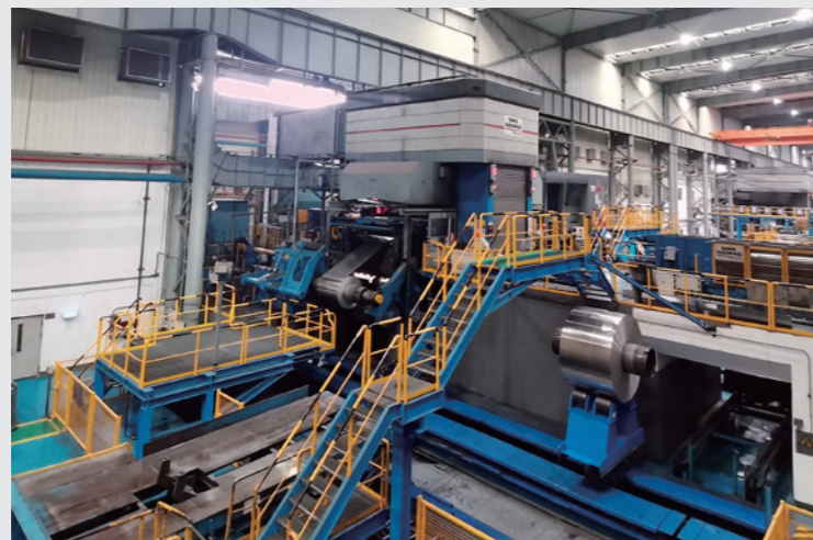
图：中孚高精铝材2500mm单机架冷轧机
