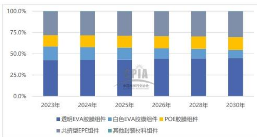
图4 2023-2030年不同封装材料的市场占比变化趋势（引用自中国光伏行业协会 CPIA）
