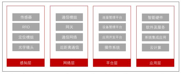
感知层能够感知识别物体或环境状态,并且实现信息的实时采集和捕获。相关信息经由网关等转化为能够识别的信息后传达到网络层,并由网络层对采集的数据进行精准、可靠地传输。平台层提供标准化/模块化的服务,实现数据处理和挖掘、连接管理、设备管理等功能。应用层则主要包括智能硬件、软件及服务、系统集成应用等内容,形成智能化应用的解决方案,从而实现物联网在众多不同领域的运用。
