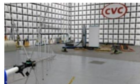
充电装置进行电磁兼容测试
