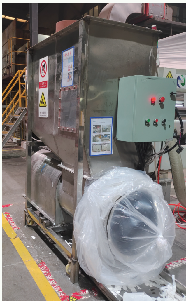
卷取环节增加纸边收集除尘装置
