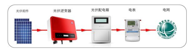
公司的光伏并网逆变器均为组串式逆变器。相较于集中式逆变器,组串式逆变器具有最大功率跟踪电压范围宽、转化效率高、组件配置灵活、性能安全可靠等特点,可满足户内、户外等不同的应用环境要求,目前已广泛应用于住宅、商业屋顶、农场、地面电站等光伏发电系统。经过多年的研发投入和积累,公司光伏并网逆变器产品种类齐全,组串式光伏并网逆变器已涵盖0.7kW~320kW 功率范围,可以全面满足各种类型光伏组件和电网并网要求,稳定高效运行于高温、高海拔、风沙、盐雾、低温等各种自然环境。
