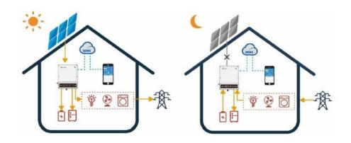
光伏储能逆变器的技术路线根据是否与电网连通主要分为并网型光伏储能和离网型光伏储能,其中以并网型光伏储能为主。离网型光伏储能系统主要应用于海岛、无电网覆盖的偏远地区等场景。随着部分国家对光伏并网发电补贴越来越低、部分区域甚至取消补贴,以及并网售电价格的下降,储能将成为提升并网光伏系统收益的重要手段。同时,光伏发电作为一种间歇性能源,发电功率的波动给电网系统带来一定冲击,储能系统可抑制或减少上述冲击,光伏并网储能逆变器将成为行业的重要发展方向之一。
