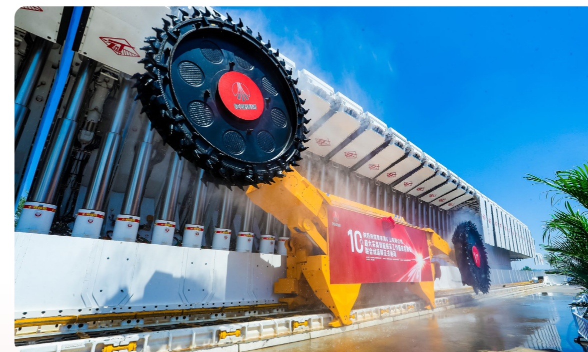
世界首套10米超大采高智能综采工作面成套装备
