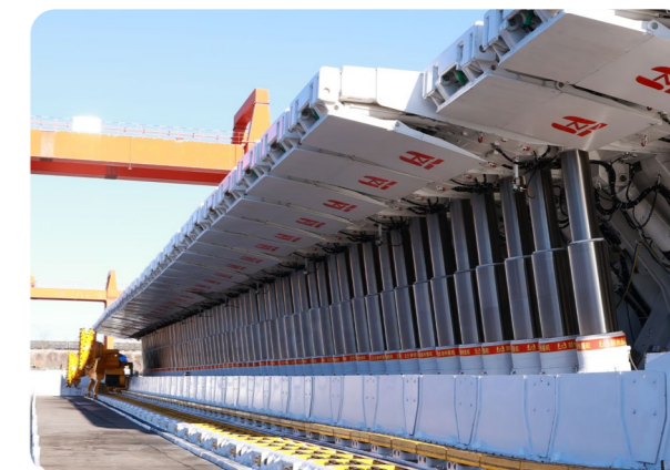
小保当一号煤矿5~6m煤层大采高工作面年产20Mt柔性生产系统成套装备地面联合试运转成功
