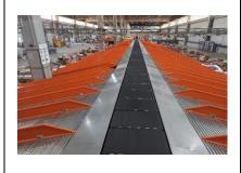
直线交叉带分拣设备系公司自有专利产品,应用场景与环形交叉带类似,当场地空间受限时可选用此类产品,主要由连续小车、主机、轨道、导入台、分拣格口、条码扫描器、直线电机、漏波电缆通讯系统和供电系统等设备组成,在垂直方向上单向直线运动,由扫描器读码、数据库地址查询后,通过小车皮带的动作平滑地将货件卸载到指定格口。
