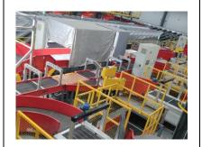
全自动供件设备通常应用在自动化分拣系统前端,由叠件分离系统、单件分离系统、转向轮产品和全自动导入台四大部分组成。该设备支持无缝对接各类自动化分拣设备,实现混堆包裹的全自动整位、叠件分离、智能排队和分拣,减少因批量包裹进入造成的线路拥堵、堆积和遗漏,具有减少人力投入、提升包裹处理效率等优点。适用于各大快递分拨中心及电商仓配中心。
