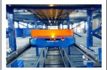
料箱穿梭车系公司自有专利产品,在拣选和配送效率要求较高的场景下,能够实现高效的储分一体化。该设备作为"货到人"拣选模式的核心设备,主要是基于小件物品的自动化存取需求,以料箱、纸箱、硬质托盘等为器具载体,对物料进行自动化存储以及高效的智能拆零拣选。应用于库存量大、小订单比例大的电商、医疗、食品冷链、3C电子、智能产线等场景。
