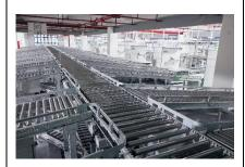
箱式输送设备系公司自有专利产品,作为大型物流仓配中心最常用的设备,主要应用于箱式货物的输送、分拣、存储及空容器的回收。该设备采用了标准化和模块化设计,可以根据客户特定需求和使用场景灵活地配置设备;通过预留标准的接口形式,可以快速高效地完成输送分拣系统的搭建。该设备集成了控制技术、视觉技术、数字交换技术、信息追踪技术等多项技术,实现物料自动、高效、准确的输送与分拣。
