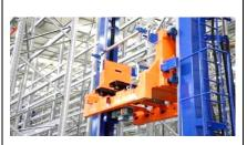
堆垛机系公司自有专利产品,由行走电机通过 驱动轴带动两夹紧的导轮,推动车轮在下导轨 上做水平行走,由提升电机通过同步带带动载 货台做垂直升降运动,由载货台上的货叉做伸 缩运动。通过上述三维运动可将指定货位的货 物取出或将货物送入指定货位。通过光电识别, 以及光通讯信号的转化,实现计算机控制,也 可实现堆垛机控制柜的手动和半自动控制。同
