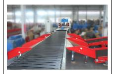
窄带分拣设备由多条等间距分布的窄型皮带组成的输送机、连续小车组成的主机、主机驱动、轨道、导入台、分拣道口、条码扫描器、通讯系统及供电系统等部分组成。设备工作时包裹经过导入台自动平稳的从主机的一端导入,经过扫描器读码,数据库地址查询后,通过小车皮带输送机动作平滑的将货物卸载到指定的道口。适用于中小型分拣场地或者底面不平的异形件的分拣应用,广泛运用于快递、电商、家居、服装、航空、化妆品等行业。
