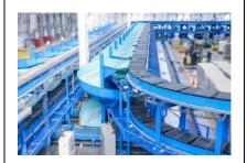
环形交叉带分拣设备系公司自有专利产品,主要用于快递物流中转场地、电商配送中心等场景,根据不同的应用工况及不同的处理能力需求选用不同的分拣设备。环形交叉带分拣设备由连续小车、主机、轨道、导入台、分拣格口、条码扫描器、直线电机、漏波电缆通讯系统和供电系统等组件组成,在水平方向上循环运动,可经过导入台自动将货件平稳地导入分拣机小车,由扫描器读码、数据库地址查询后,通过小车皮带的动作平滑地将货件卸载到指定格口。
