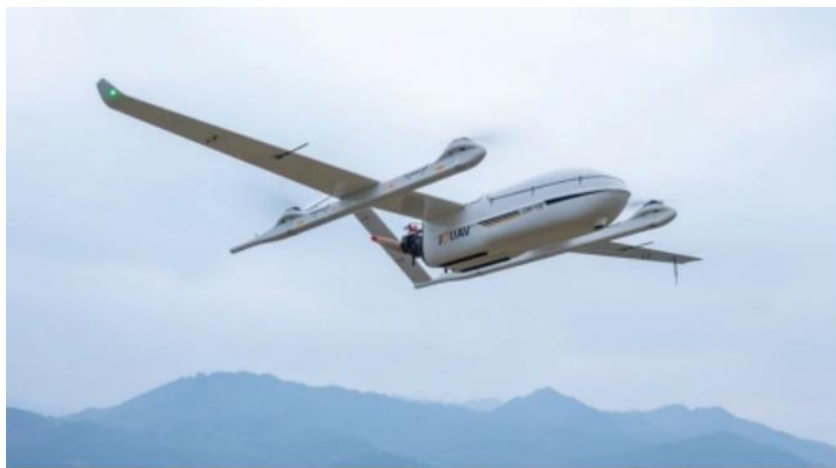
图 纵横大腾 CW-100 垂直起降固定翼无人机
