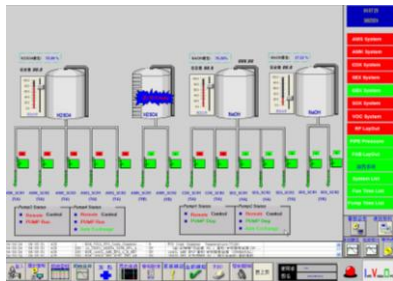
废气监控系统
