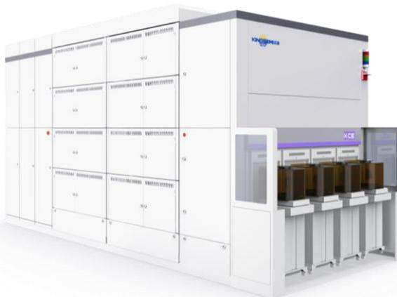
①高工艺覆盖性：设备适用于薄膜前后清洗、干法蚀刻后清洗、离子注入灰化后清洗、CMP后清洗等多种清洗工艺，能够适配高温 SPM 工艺，整体工艺覆盖率达到 80%以上。
