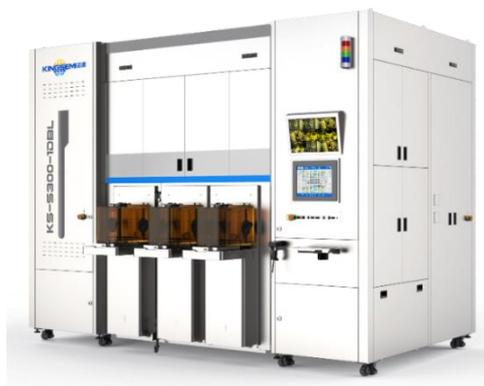
目前，国内高精度临时键合设备市场长期被海外厂商高度垄断，针对 Chiplet 技术解决方案，公司提前布局自主研发的全自动临时键合及解键合机，可应用于 InFO、CoWoS、HBM 等 2.5D、3D 技术路线产品，兼容国内外主流胶材工艺，能够适配 60 微米及以上超大膜厚涂胶需求，可实现高对准精度、高真空度环境、高温高压键合工艺，键合后产品 TTV 及翘曲度表现优异，对应开
