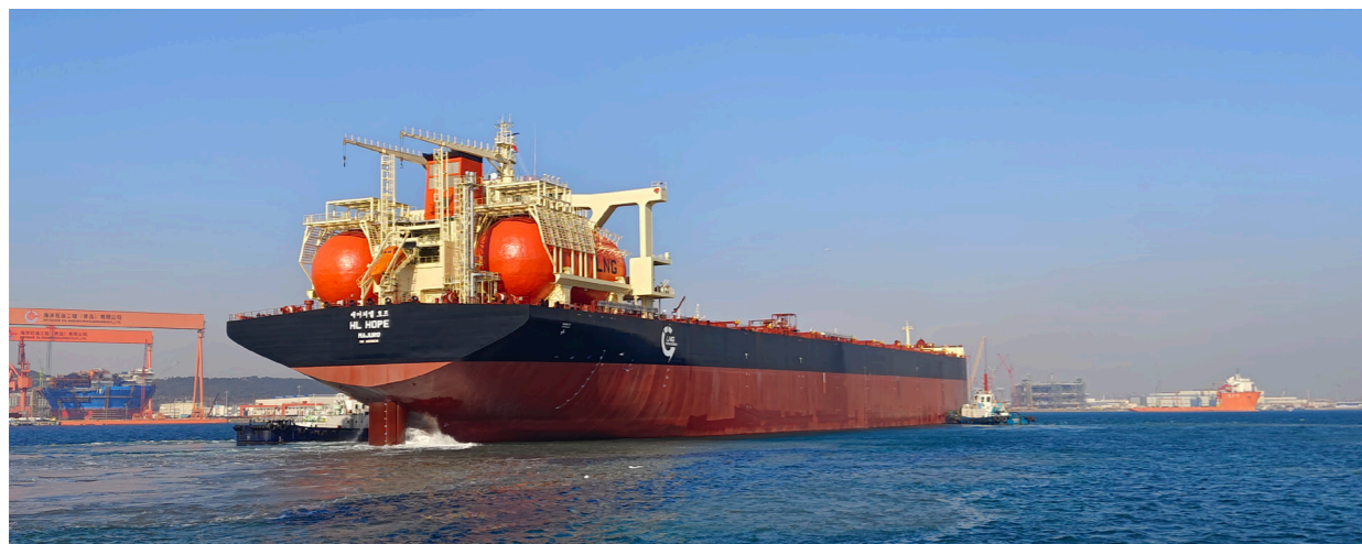
青岛北海造船有限公司 21 万吨 LNG 双燃料散货船
