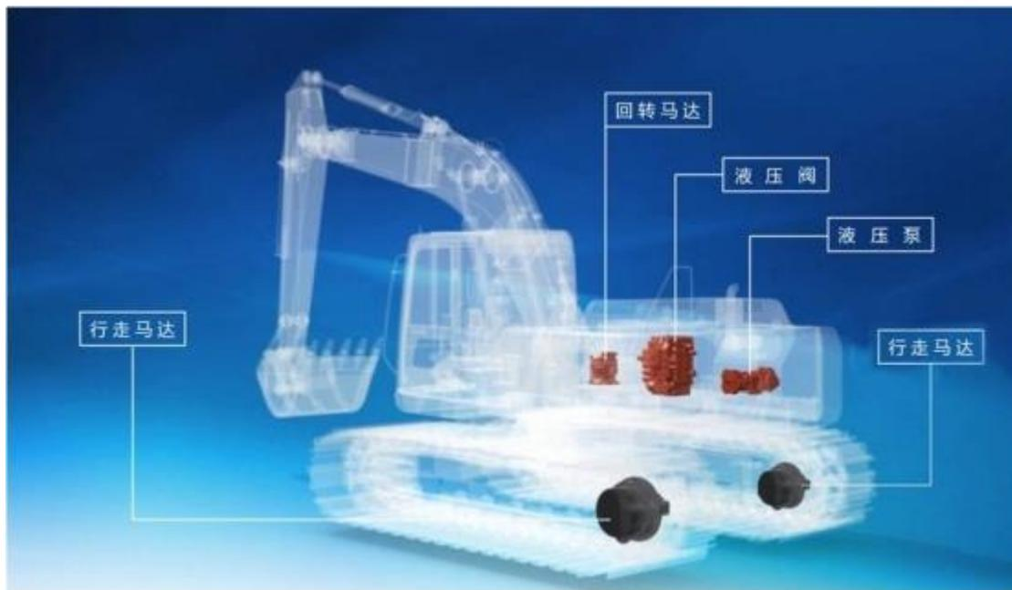
液压泵向整个液压系统提供动力；行走马达直接与液压机械的履带驱动轮或车轮相连接，驱动其直行
