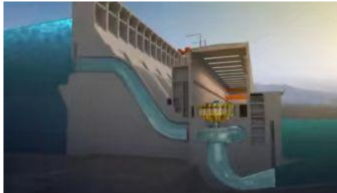
水电站取水和排水示意图
