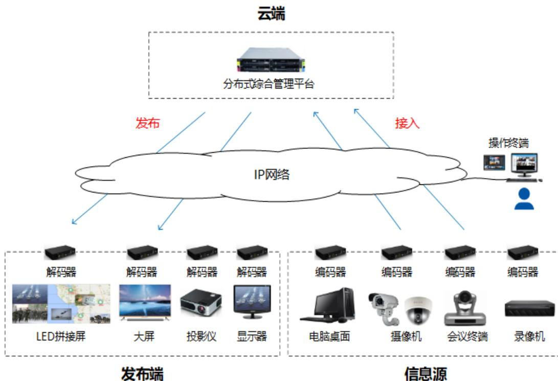
分布式音视频控制系统采用全IP化分布式控制和编码技术，实现了多源音视频信息分布式接入和发布的网络化控制，使得音视频传输更远，跨席位、跨房间、跨楼宇、跨区域之间发布、分享更便捷。分布式音视频控制系统采用软硬件结合的采集编码技术，实现视频低码、低时延的全彩效果，视频效果与无损压缩效果相近的同时，又极大降低了传输网络带宽和存储的要求；采用媒体流分布式处理技术，全网处理能力均匀分布，避免存在网络、性能瓶颈节点，且容量自由扩展，任何点位出现故障不影响其他点位正常使用。区别于传统模拟/数字视频切换矩阵设备集中式信号接入和切换输出的模式，并具有以下特征：
