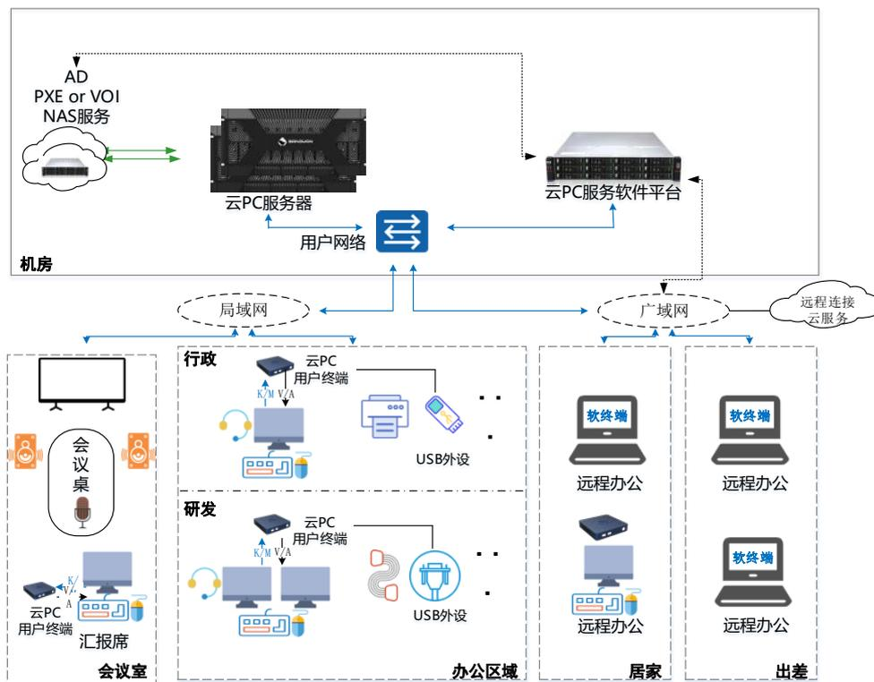
邦彦云 PC 是一种将电脑主机云化的解决方案，通过将个人计算机的操作系统、用程序和数据存储在上云端的服务器上，并通过互联网连接到这些服务器，用户可以通过终端设备访问和操作自己的云 PC 桌面环境。该产品提供了灵活性、便捷性、安全性和成本效益等多种优势，使用户能够随时随地进行工作，并享受与本地计算机相似的体验。同时，用户也可以从集中管理、资源共享和成本节约等方面受益。具有以下特征：
