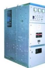
**产品简介：**产品分室结构，上层为母线和仪表室（相互隔离），中间层为断路器室，下后面为母线室，下层为电缆室，由于断路器在中间层，俗称中置柜；产品由柜体、母排、套管、触头盒、微机保护、二次控制、接地开关及核心部件-真空断路器等构成。
