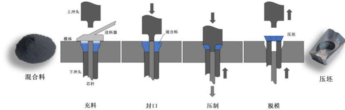
公司在多年的生产过程中，形成了一套精准的压制工艺控制技术和尺寸公差控制标准。公司产品的压制生产都根据模具压制试验确定的参数和混合料鉴定的参数进行科学严谨的计算，从而确定压制生产工艺参数，切实保证压坯达到公司建立的尺寸公差标准要求。公司通过在压制成型过程中对压坯单重进行自动监控和自动调节，实现压制成型的自动化生产和自动化尺寸公差控制，进一步提高压坯精度，并减少压坯缺陷。
