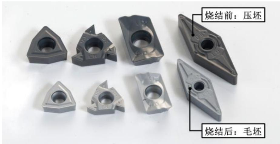
在烧结工艺的控制中，烧结温度和烧结时间是影响烧结收缩形变的最主要工艺参数，不同成分、不同尺寸硬质合金基体对烧结温度和时间的敏感程度存在差异。公司经过多年的研究和生产，制定了与基体牌号匹配的多种烧结工艺，通过对烧结温度、烧结时间、烧结压力、烧结气氛等工艺参数的控制，实现了对不同基体牌号烧结成型精度一致性的控制。
