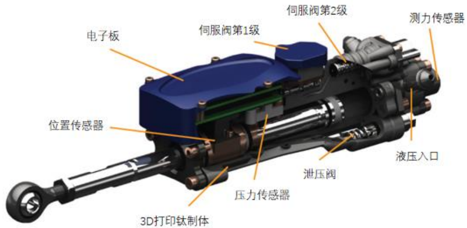
电液驱动关节结构示意图
