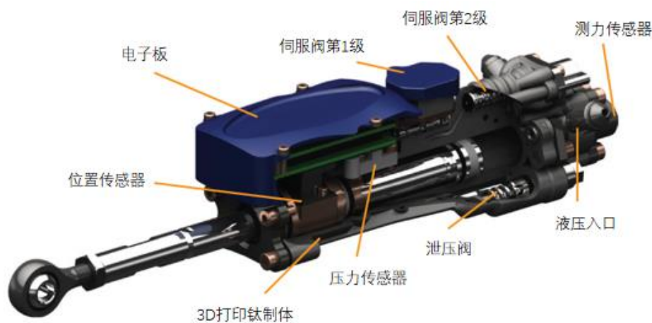
电液驱动关节结构示意图
