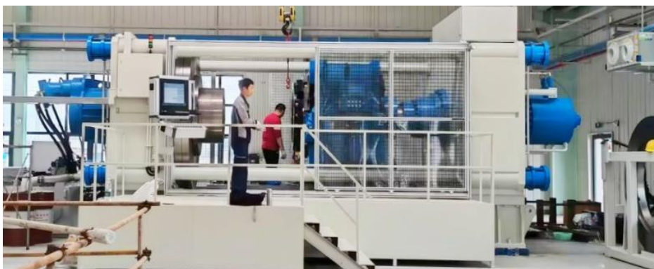
图 6 560T 摩擦焊设备
