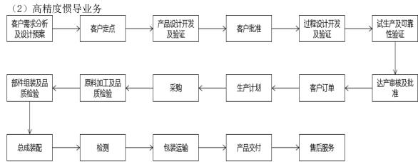
公司在产品设计开发及生产业务的运作中通常先根据客户的技术需求,完成产品的售前技术方案,签订合同后再根据客户的技术协议书进行更具体的设计开发及验证,然后根据客户订单,基于 MES 和 WMS 系统,依次进入排产、采购、生产、检验等阶段,最终发货完成产品交付。
