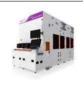
可用于 6-8 英寸各种半导体材料抛光,拥有四个独立的抛光单元,工艺搭配灵活,产出率高,满足第三代半导体、MEMS 等制造工艺。
