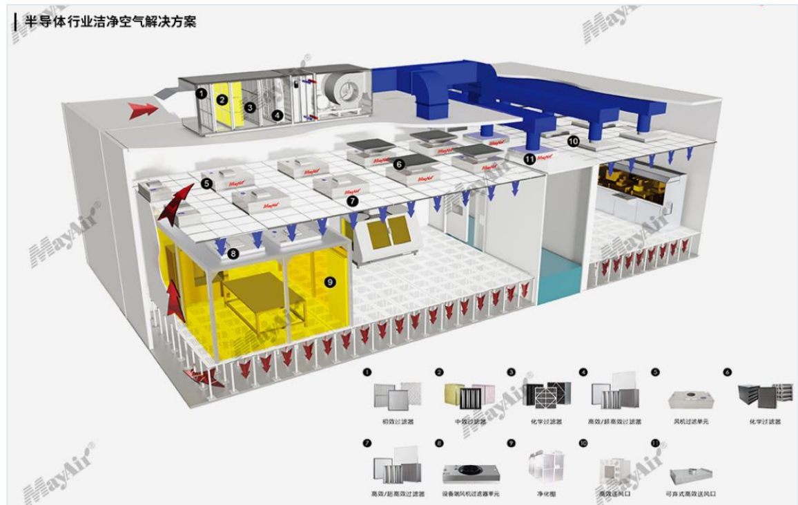
图表 6：半导体洁净厂房的主要结构示意图
