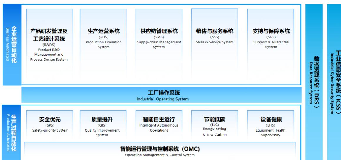
公司全面推进产品整合与升级，围绕流程工业智能工厂高质量生产与智慧运营需求，贯穿企业全领域数据资源系统（Data Resource System, DRS）以及多层纵深的工业信息安全系统（Industry CyberSecurity System, ICSS），形成企业运营自动化（BA）及生产过程自动化（PA）两大产品体系。
