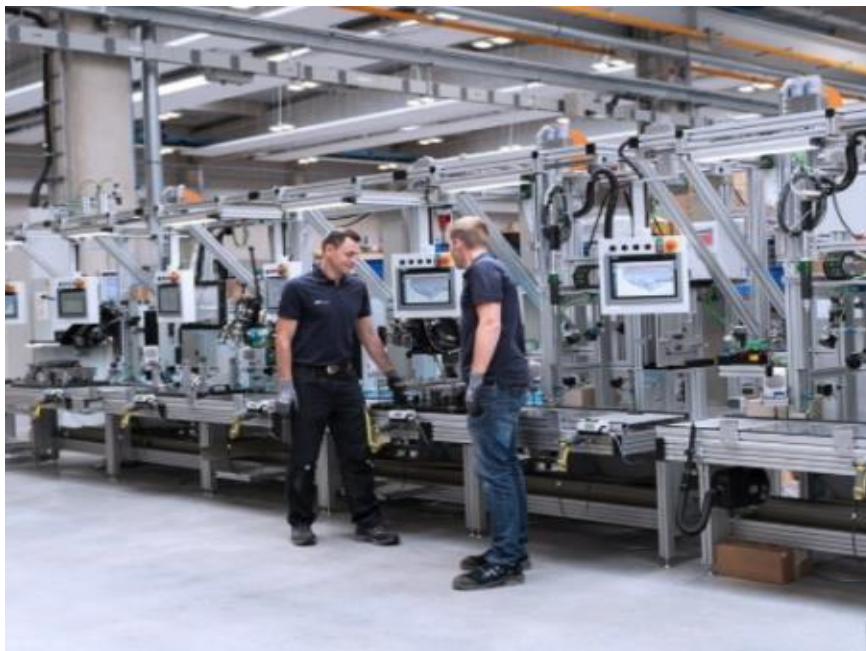
图：800V 变压测试系统
