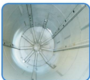
掺混料仓内部贴壁掺混管
