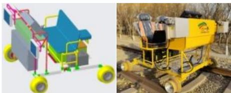
该产品采用模块化、轻量化设计，现场 2 人即可快速拆分上下道，在站台与轨道间快速传送。可灵活搭载多套检查装置，目前已搭载基于机器视觉的轨道智能巡检系统，可扩展隧道巡检系统、隧道限界检测系统等。在编码器和 RFID 辅助定位基础上，开发了轨枕编码识别定位系统。新的定位技术依靠图像识别，实现地下空间线路检测的里程定位，可解决线路长、短链对准确里程定位的影响。
