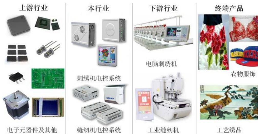
电脑刺绣机在电控系统的控制下，可以驱动挑线、机针、绣框、换色、剪线等多个复杂的机械机构，进而带动机针和绣线形成线环，使绣线在面料上产生特定线迹。公司刺绣机电控系统在细分领域的市场占有率第一，产品不断向高端化和智能化发展，推动行业技术革新。
