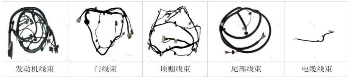
仪表板线束、车身线束、门线束、顶棚线束及尾部线束等。汽车线束是汽车电路的网络主体，是为汽车各种电器与电子设备提供电能和电信号的电子控制系统。
