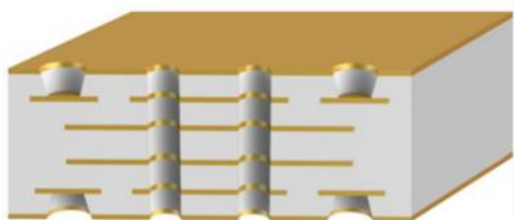
化学沉铜前 (孔壁绝缘基材无铜覆盖)
